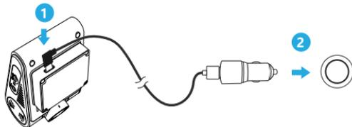
Stecken Sie den USB Adapter in die 12V / 24V Steckdose Ihres Fahrzeugs. Stecken Sie den Stecker des USB-Kabels in den USB-Anschluss der Kamera.
