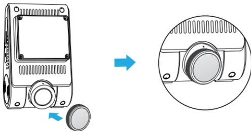
Bei der Installation von CPL müssen Sie die weißen Symbole auf der Kamera für die Installation ausrichten.
