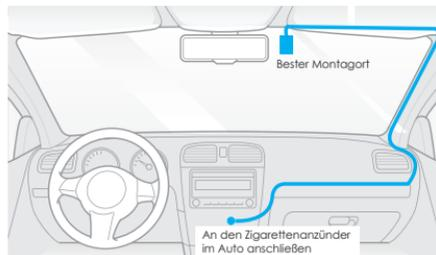
2. Wischen Sie die Montagefläche der Windschutzscheibe mit einem trockenen Tuch ab. Diese muss fettfrei sein, damit das Klebepad fest haftet.
